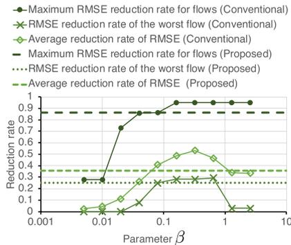
Fig. 14 Effect of edge weight parameter  $\beta$  for radius parameter  $r = 0.001$ .
