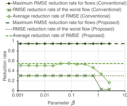
Fig. 13 Effect of edge weight parameter  $\beta$  for radius parameter  $r = 0.1$ .
